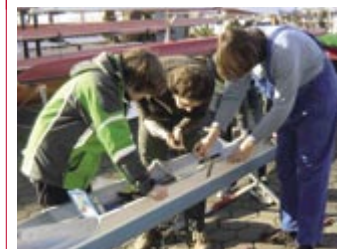
Henry und Alistair helfen beim Ausbohren der Auslegerbolzen. Unterstützung gab es dazu noch vom Kameraden Johannes Daum.
